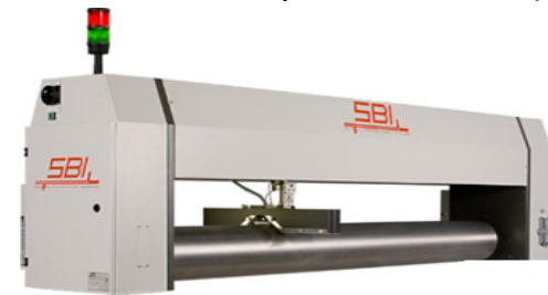
Sistema SHADOW: Medición por sombra de láser (No radioactivo)
